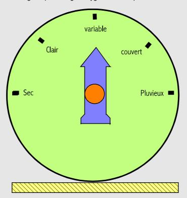
Lorsque le degré d'humidité de l'air (qui entre par les trous d'aération) augmente, la couche de gélatine de la face brillante du papier photographique se dilate. La bande alors se déroule et la flèche oblique vers la droite. Lorsque l'humidité diminue le papier s'enroule et la flèche
