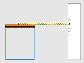
Lorsque la pression atmosphérique augmente, l'air au dessus du ballon exerce sur lui une force plus grande qui le pousse vers le bas. Le ballon se creuse et l'extrémité pointue de la paille monte. Lorsque la pression atmosphérique diminue la force exercée sur la ballon se réduit, celui-ci se gonfle et l'extrémité pointue de la paille descend. La graduation permet de relever les positions journalières et de visualiser les variations.
