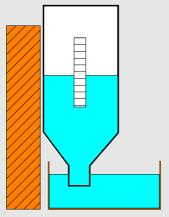
Lorsque la pression atmosphérique augmente, l'air au dessus de la surface de l'eau du récipient exerce une force plus grande. Le niveau de l'eau dans le récipient descend et donc celui dans la bouteille monte.
